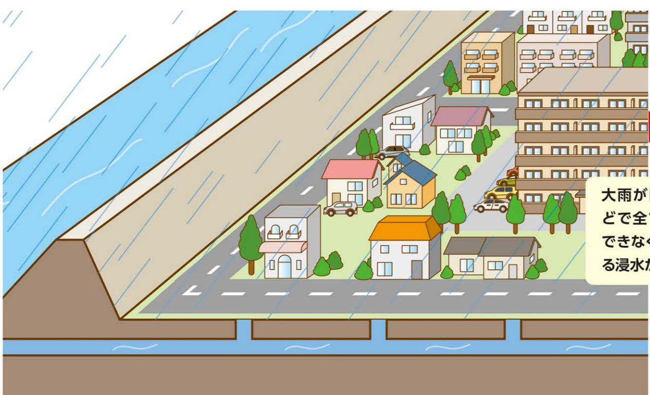
宅地に降った雨は雨水ますへ、道路に降った雨は道路側溝などに集まり、下水道や水路等を通して河川に排水されます。
