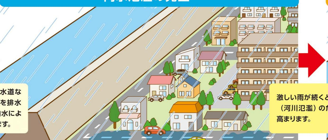
内水氾濫とは、雨の量が下水道などの排水能力を超えたときや、河川などの排水先の水位が高くなったときに雨水を排水できなくなり、浸水することです。
