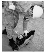
手順6 初爆(ボンという音がする)が起きたら、「⑧デコンプバルブ」を再度押し込み(デコンプバルブは初爆時に元に戻ります)、「⑪チョーク」を戻す。
