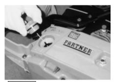
燃料は、市販されている混合燃料 無鉛ガソリン+2サイクル専用オイル=20:1を 使用します。(25:1も可)
