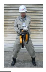
切断時はスロットルトリガーを強く(全開)握り、 エンジンの回転数を最速にする。切断中は回転を緩めない。
