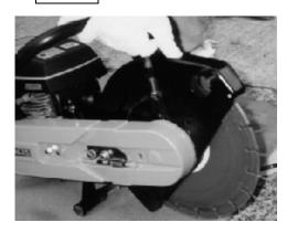
エンジンカッターで金属などを切断する際は火花が 散るため、カバーを調整し自分に火花がかからない ようにする。
