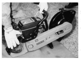
スタートハンドルを引かずにエンジンを停止させた 場合は、自動巻戻しの力によりスタートハンドルの 先にあるスタートロープが切れる恐れがあります。 必ず、スタートハンドルを軽く引いた状態で、 エンジンを停止させてください。
