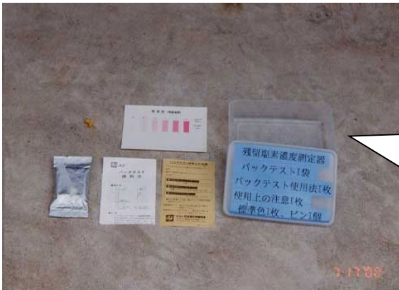
(6) 残留塩素濃度測定器 (パックテスト1袋、パックテスト使用 用法1枚、パックテスト使用上の注意 1枚、標準色1枚、ピン1個)
