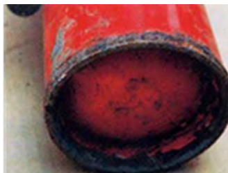
錆や塗装の剥離
