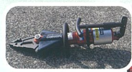
油圧切断機 金属などを切断または拡張し、隙間をつくる資機材
