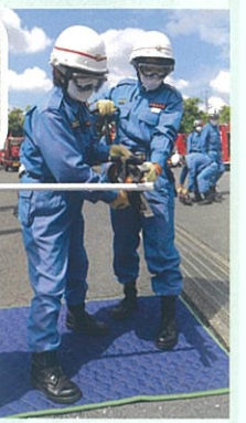
油圧切断機 金属などを切断または拡張し、隙間をつくる資機材
