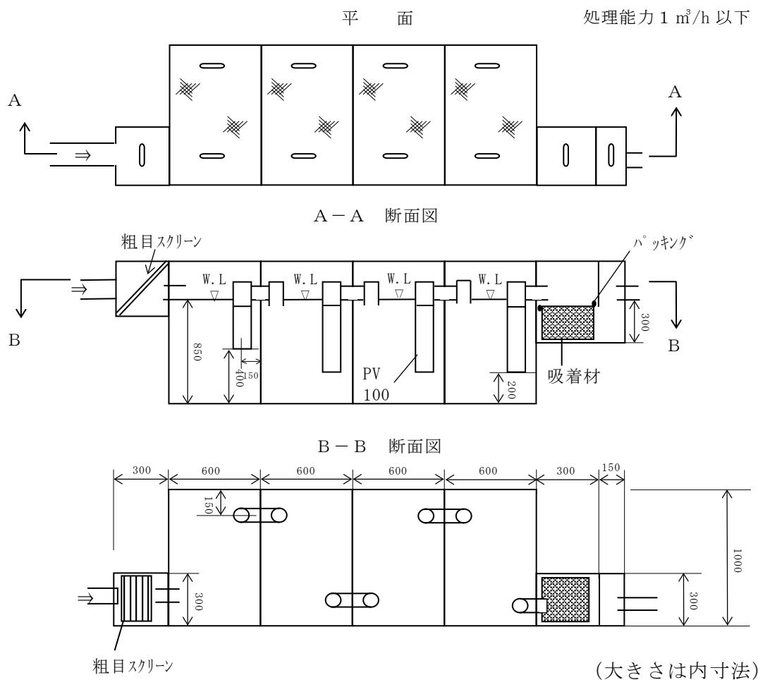
構造寸法：排水量  $1\text{ m}^3/\text{時}$ 以下の場合における $2\text{ m}^3$ 槽の大きさの例（有効寸法）
