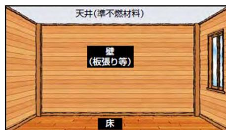
図 6-1 難燃材料に準じた内装の仕上げ
