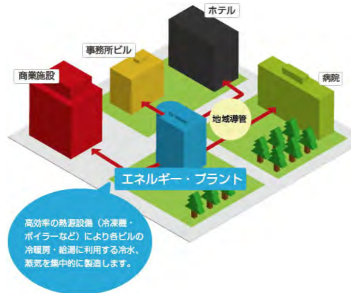
地域冷暖房のしくみ（出典：みなとみらい21 熱供給株式会社 HP）
