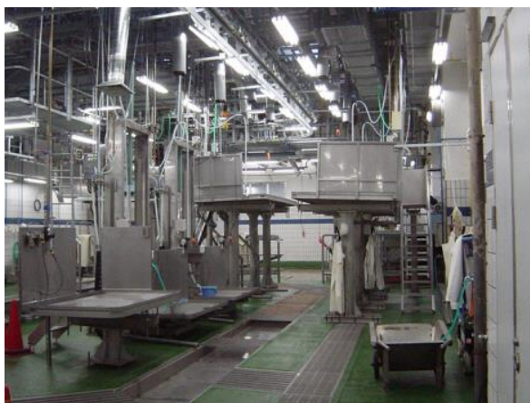
図表 大動物解体ラインのオンレール方式
