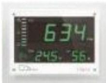
換気グッズ (co2モニター)の設置
