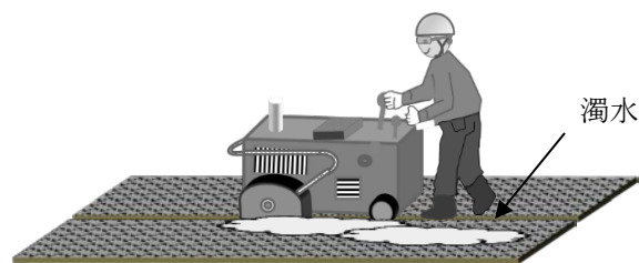
図表2-1-2-7 舗装切断作業のイメージ
