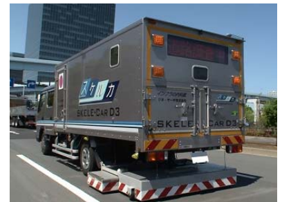
空洞探査車による調査
