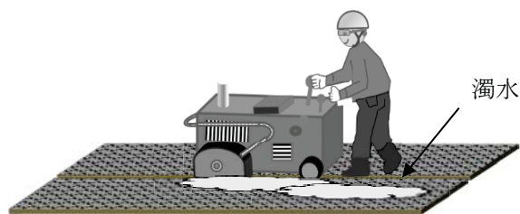
図表2-1-2-7 舗装切断作業のイメージ
