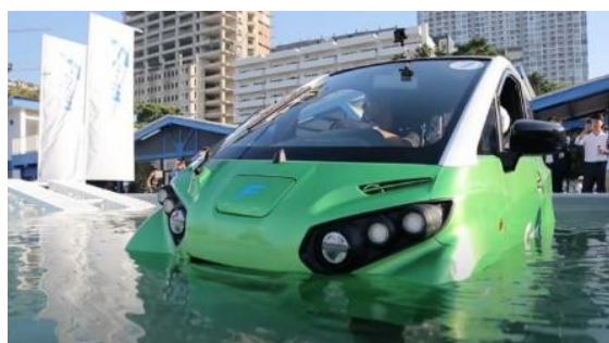
緊急時には水に浮く電気自動車 （写真提供：株式会社FOMM）
