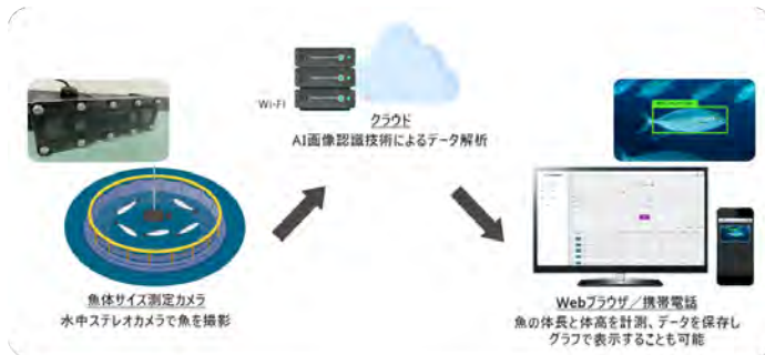
AI 魚体サイズ測定カメラの仕組み
