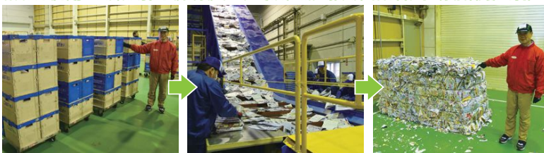
①コンテナ(プラ箱)64箱分のお買物めも ②人の手で異物除去後、機械で圧縮されて ③こんなに小さくなりました。約1トン!
