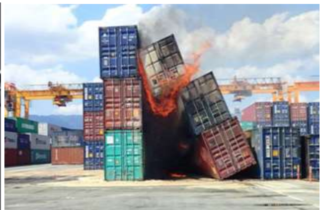
コンテナの火災 (浸水による)
