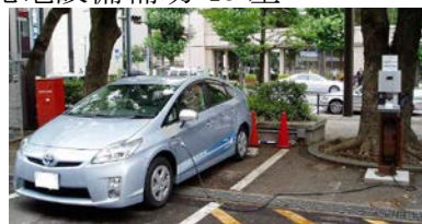
プラグインハイブリッド車と充電設備
