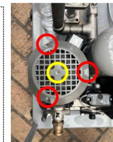
プロペラ部が固着し、回転しない場合は、赤丸のネジを緩め、カバーを外し、黄丸部をマイナスドライバー等で回転させてください。
