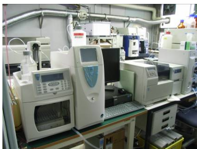
イオンクロマトグラフ(陰イオン)装置 イオンクロマトグラフーポストカラム装置
