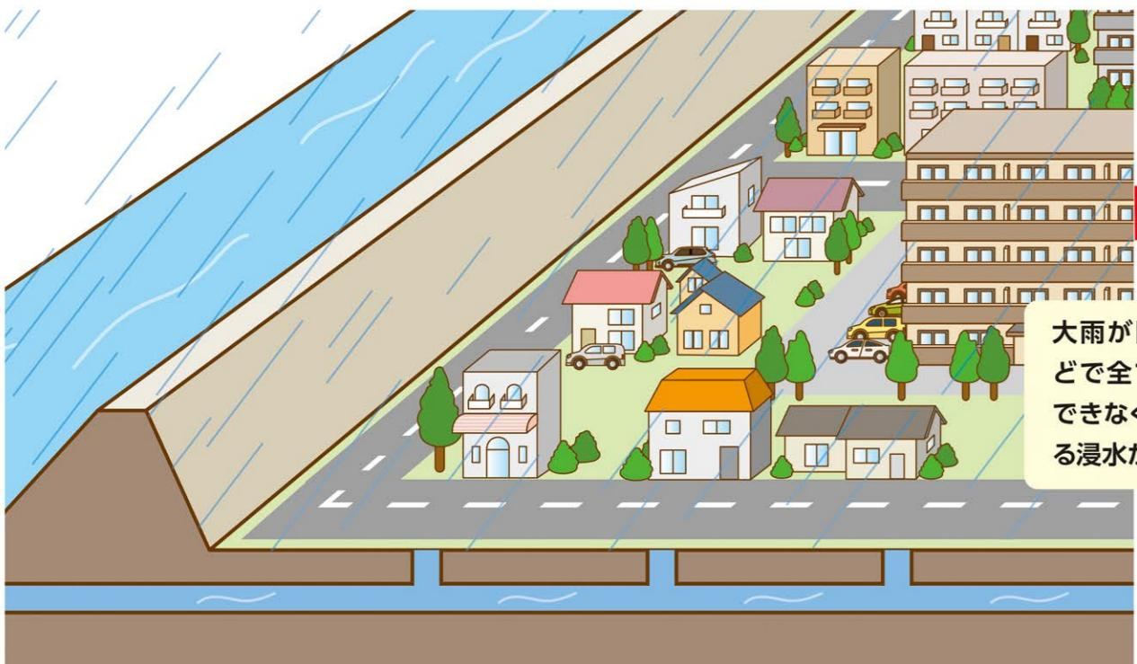
宅地に降った雨は雨水ますへ、道路に降った雨は道路側溝などに集まり、下水道や水路等を通って河川に排水されます。
