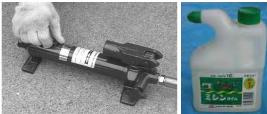
2) 給油口のねじを外し、「一般油圧作動油 (ISO VG10 など)」を給油する。
