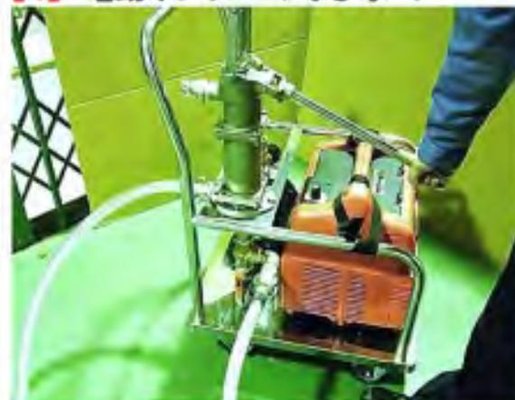
\* 手押しポンプから水が出るまで運転し、取水ホース内の空気を抜いてください。
