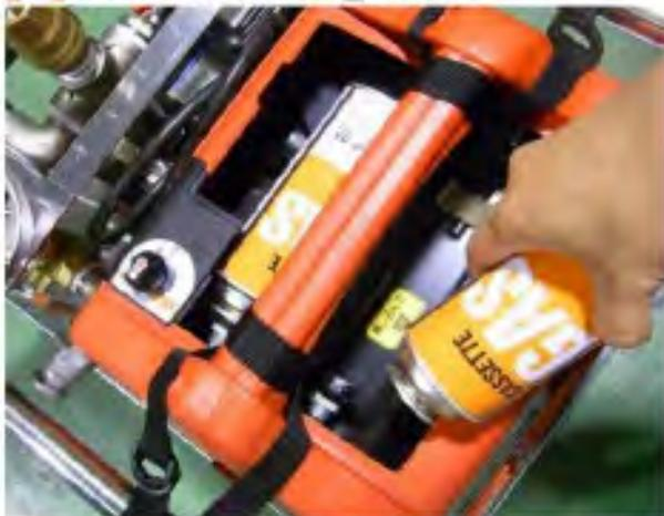
\* 発電機の上部カバーを外し、カセットポンペをセットします。
