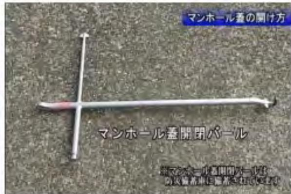
**手順2** マンホール蓋開閉パールの先端をマンホールのロック部に水平に差し込み、マンホールの蓋を引き上げつつ、回転させ、マンホール蓋を地面に置きます。
