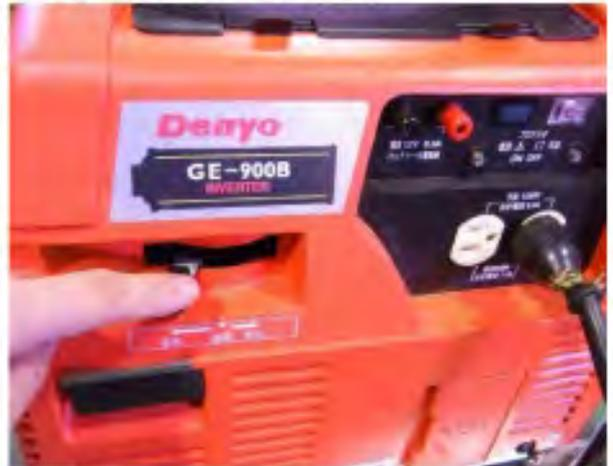
\* 発電機を2分ほど暖気運転し、電動ポンプのコンセントを発電機に差し込んでください。エンジンスイッチを〈運転〉にすると、電動ポンプによる送水が行われます。
