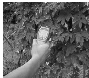
放射温度計で表面温度を測る様子
