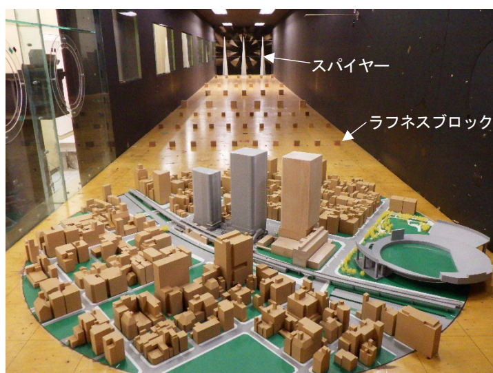
写真 6.10-2 ラフネスブロック及びスパイヤーの設置状況
