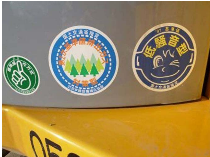
写真 4-5 環境保全のための措置の実施状況（環境対策型建設機械の使用）
