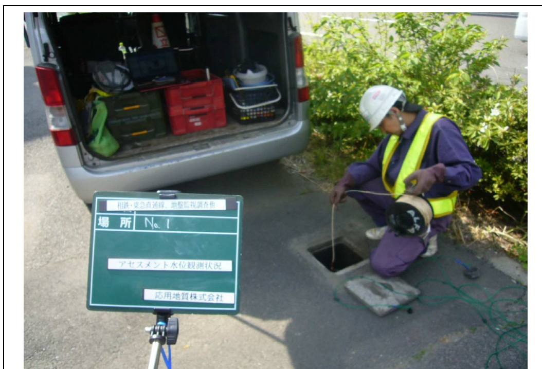
写真 2.4.1-1 環境保全のための措置の実施状況（地下水の観測）
