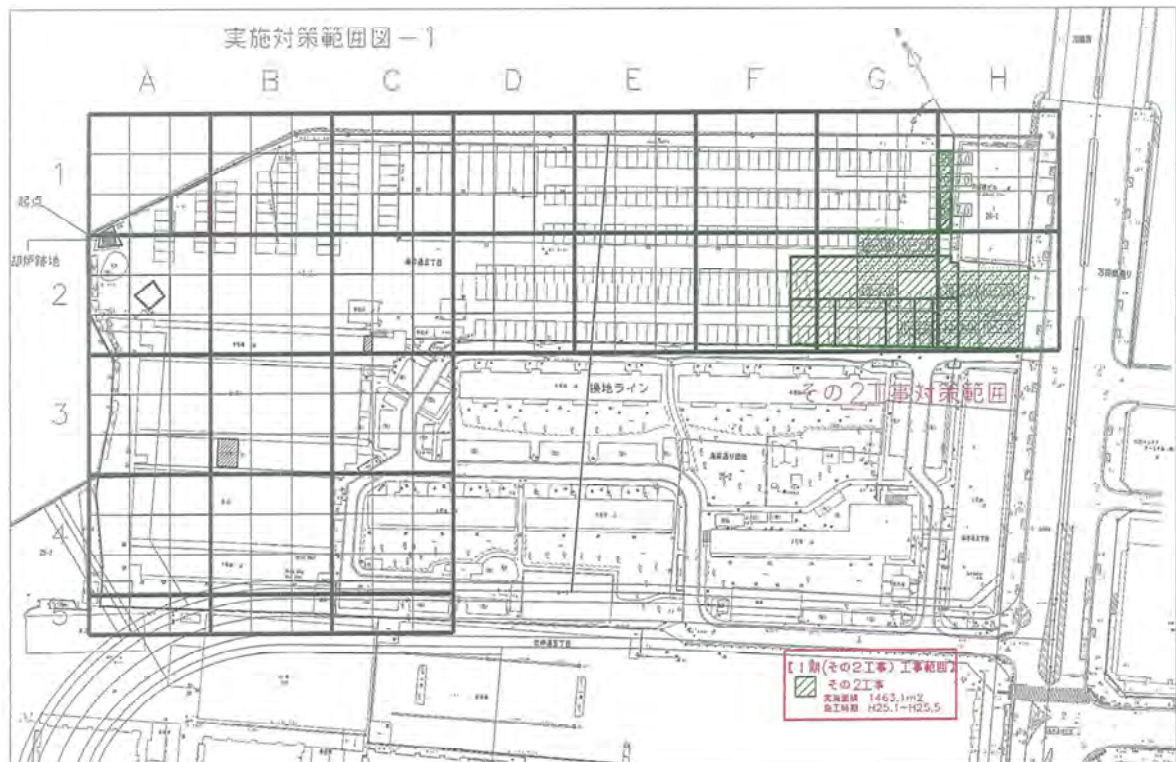
図 6.5-5 汚染土壌確認位置及び対策完了範囲図(倉庫敷地)
