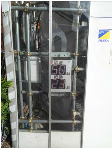
写真 3.1-11 騒音・振動計による常時観測
