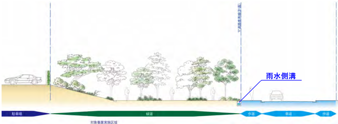
図2.3-7 西側敷地の西側における雨水側溝位置の断面イメージ図
