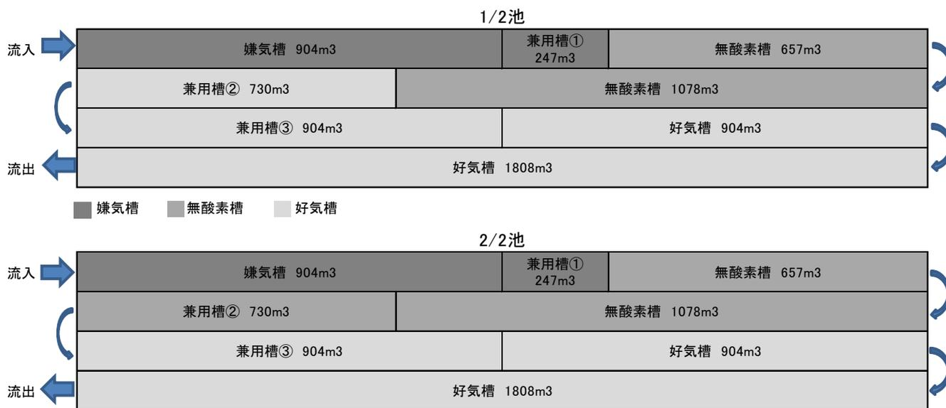
図1 第1系列1/2及び2/2反応タンクフロー
