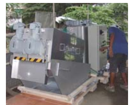
導入された汚泥脱水機
