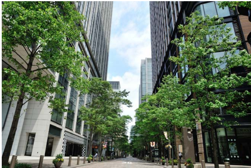
参照事例A： 分節箇所を隣地と揃え、連続性を持たせた街並み 歴史的建造物やその意匠特性・高さなども踏まえている
