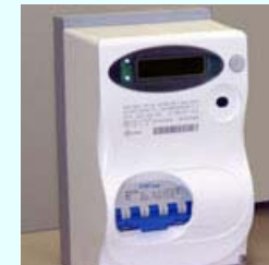
スマートメーター
