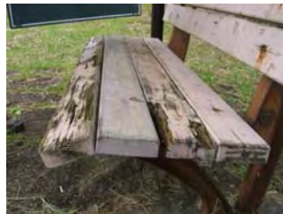
②腐朽の中期段階
