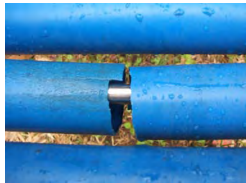
▲ ローラーすべり台のローラー破損
