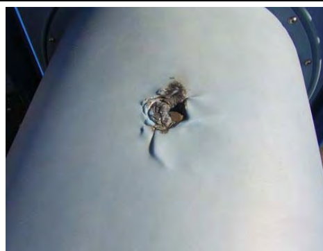
▲ チューブトンネルの焦げ跡
