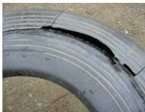
ゴム系素材の劣化状況
