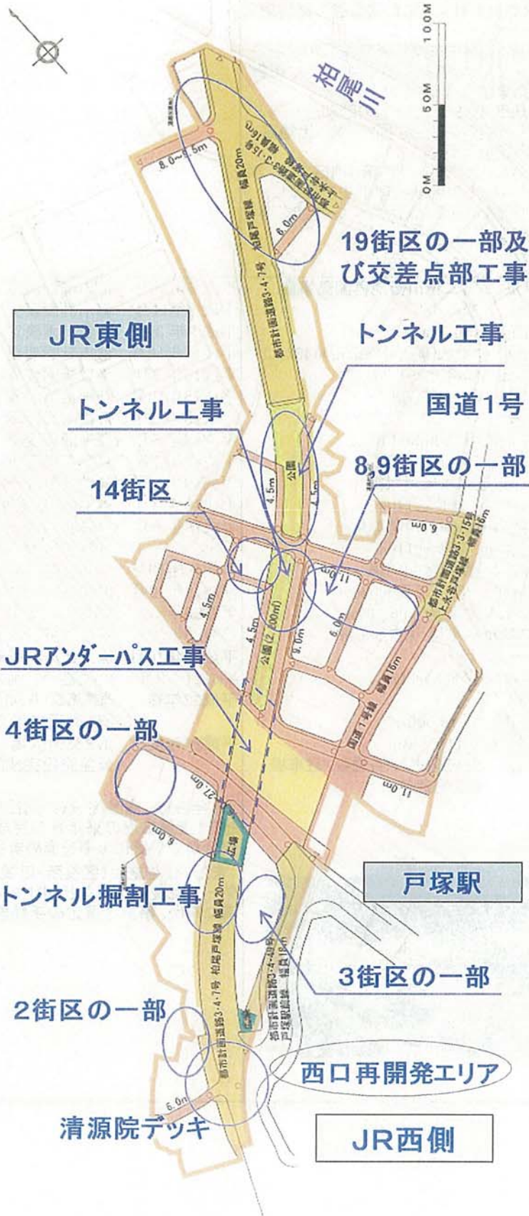
現在工事施工箇所図
