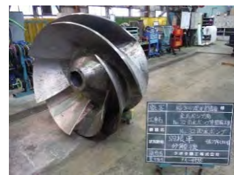
ポンプの再整備（長寿命化）
