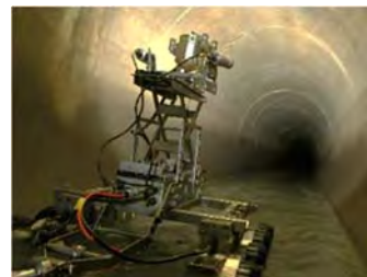
中大口径管用 TV カメラの例
