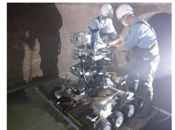
中大口径管用 TV カメラの例
