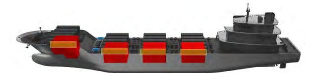
蓄電池を搭載した電気運搬船
